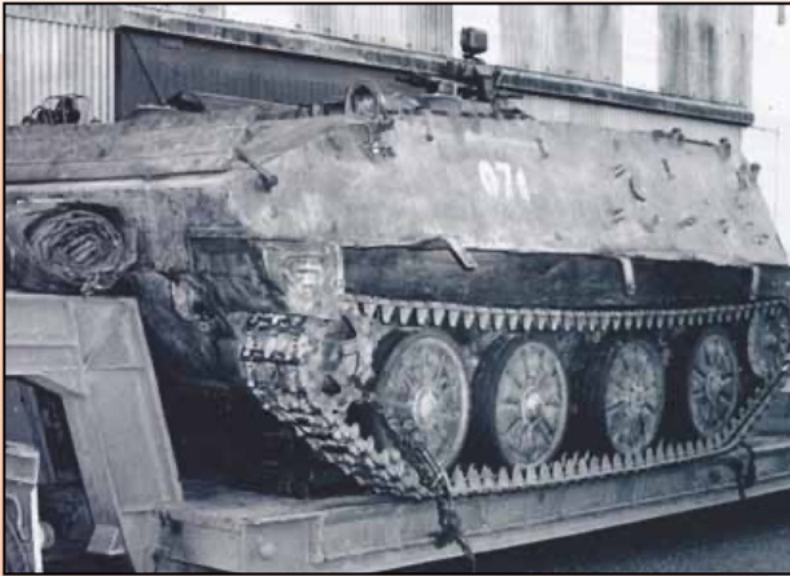
De YW531 op z'n dieplader op weg naar her Engineering Design Establishment. Duidelijk is te zien dat de rupsbandschermen ontbreken en dat de koplamp behoorlijk is beschadigd.
